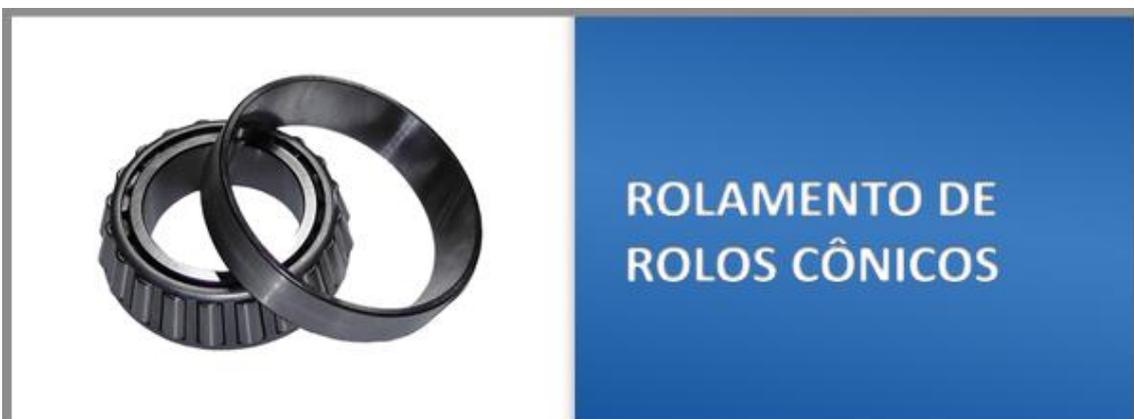
Carga suportada variável por ângulo de contato, comportam cargas radiais pesadas e axiais em um sentido. Geralmente montados em oposição a outro do mesmo tipo.
