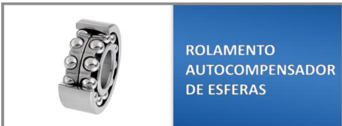
O rolamento autocompensador de esferas é ideal para operações com desalinhamentos, cargas radiais e velocidades elevadas. A folga radial pode ser normal ou aumentada. Além disso, os rolamentos autocompensadores de esferas apresentam o menor atrito entre todos os outros rolamentos, o que lhe permite funcionar bem em alta velocidade com uma temperatura baixa.
