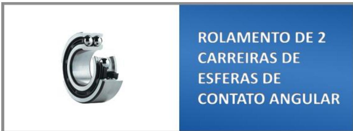
Os rolamentos de 2 carreiras de esferas de contato angular suportam cargas axiais nos dois sentidos e suportam cargas combinadas com componente axial predominante.
